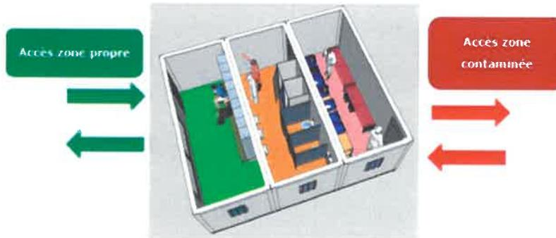
Figure 2 : Exemple d'un SAS de décontamination
